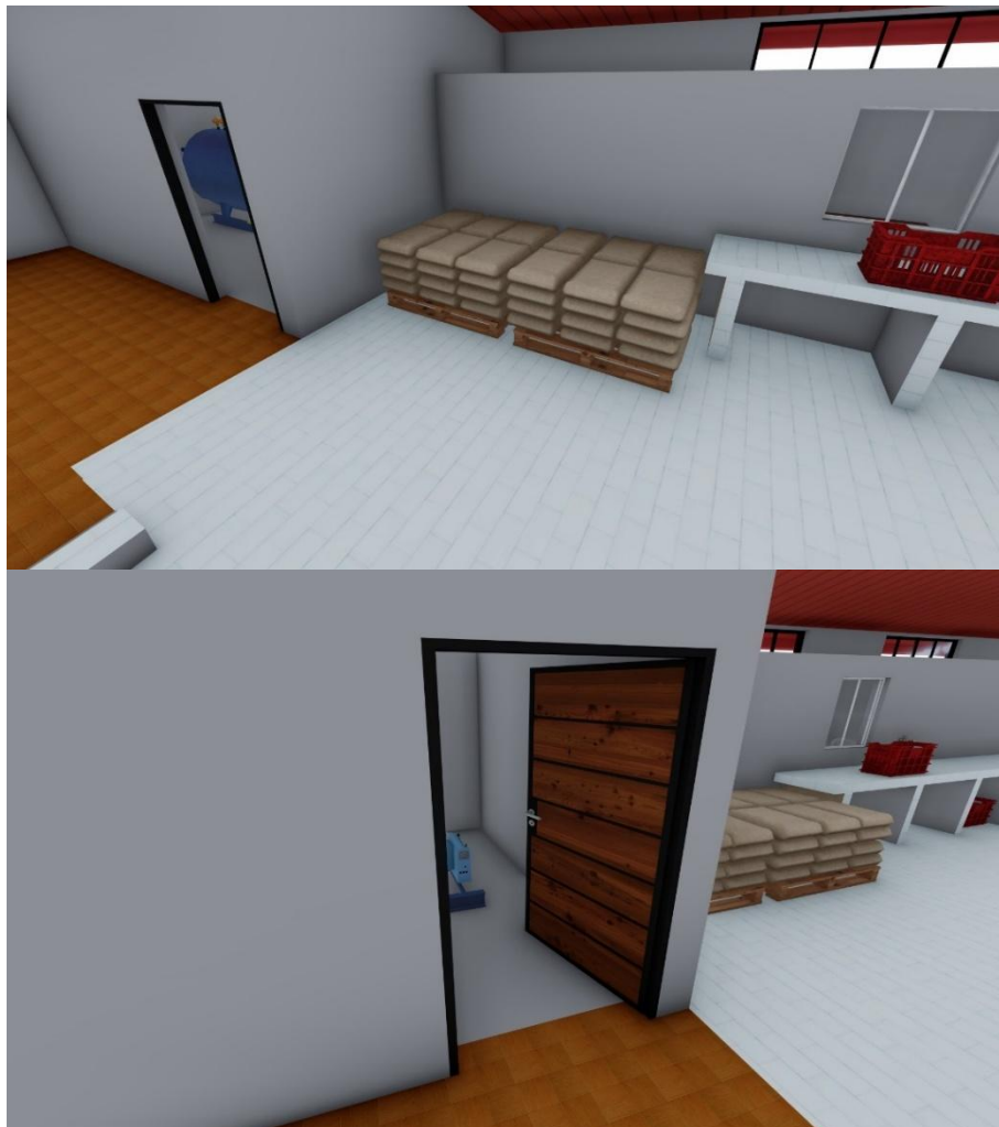
Figura 57. Adecuación de almacén y cambio de sentido de puerta caldero
