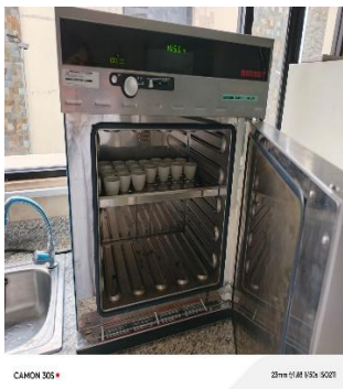
Figura 59. Llevar a peso constante los crisoles 130 °C por 1 h
