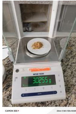
Figura 66. Pesar 3 g de la muestra molida en papel filtro Whatman No-1
