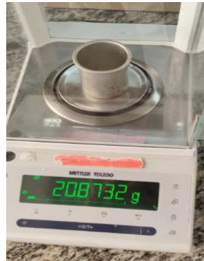
Figura 69. Pesar los vasos de extracción
