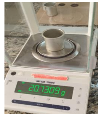
Figura 73. Retirar los vasos y dejar enfriar, luego pesar los vaso con el extracto
