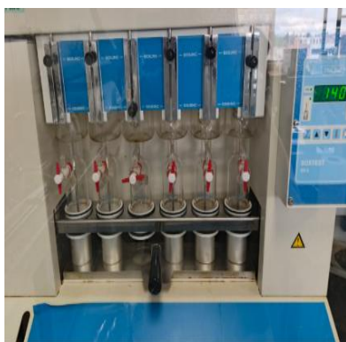
Figura 32. Precalear el equipo a 140 °C y colocar los dedos en inmersión por 3 h. Pasar a la posición de lavado por 1 h, y recuperación 37 min.
