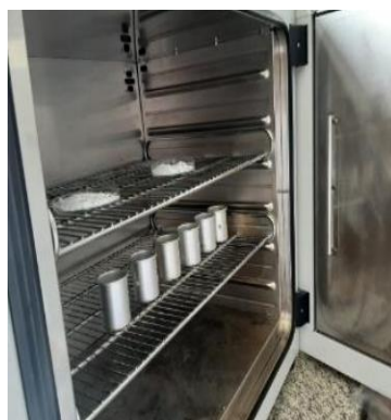
Figura 33. Secar los vasos de extracción en la estufa a 105 °C por 2 h
