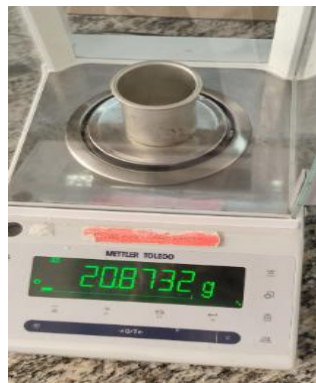
Figura 30. Pesar los vasos de extracción
