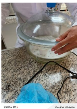
Figura 10. Llevar a peso constante los crisoles 130 °C por 1 h, análisis de ceniza
