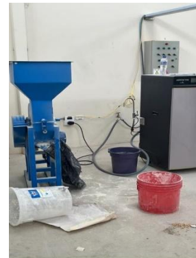
Figura 6. Molienda de los granos en molino de martillos
