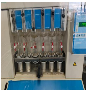
Figura 71. Precalear el equipo a 140 °C y colocar los dedales en inmersión por 3 h.
