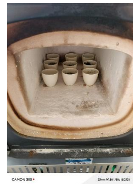
Figura 55. Obtención de cenizas en mufla a 550 °C por 2 h
