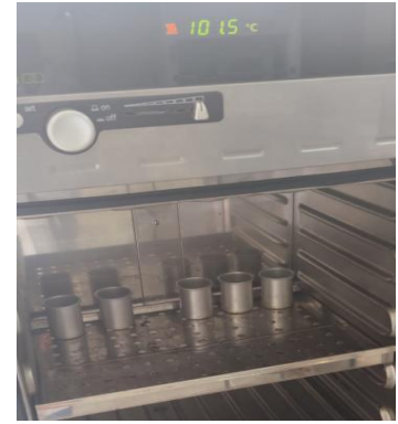
Figura 67. Llevar a peso constante los vasos de extracción 130 °C por 10 min
