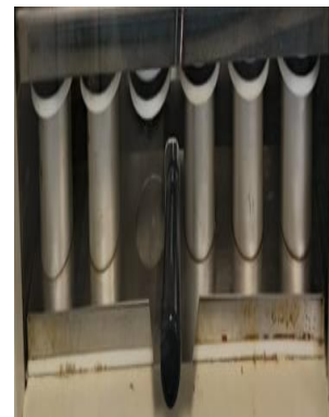
Figura 31. Pesar 60 mL de hexano y colocar al vaso de extracción
