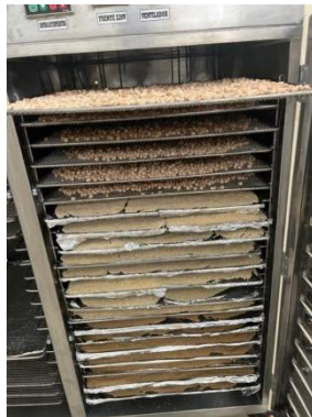
Figura 5. Deshidratado de los granos 80-85 °C por 20 min
