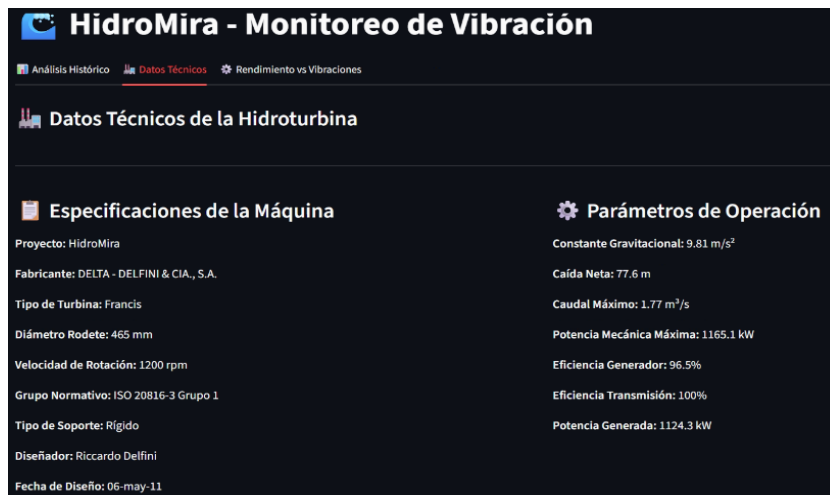
Figura 13. Dashboard 2 – Especificaciones Hidroeléctrica
