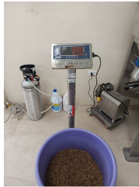
Figura 4. Pesaje de bagazo seco antes de la molienda
