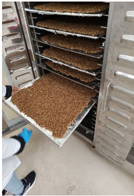
Figura 3. Deshidratación de e bagazo de cerveza tipo Pale Ale
