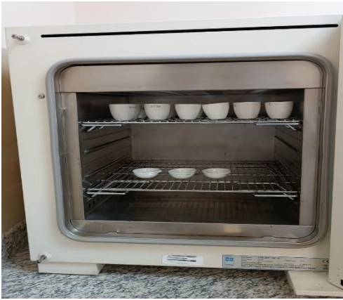
Figura 22. Determinación de humedad
