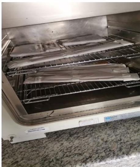
Figura 31. Esterilización de materiales de laboratorio vía seca.
