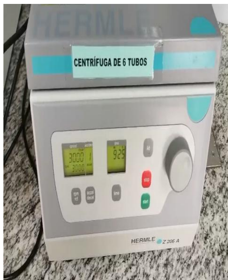
Figura 25. Análisis de Sinéresis por medio de Centrifugación.
