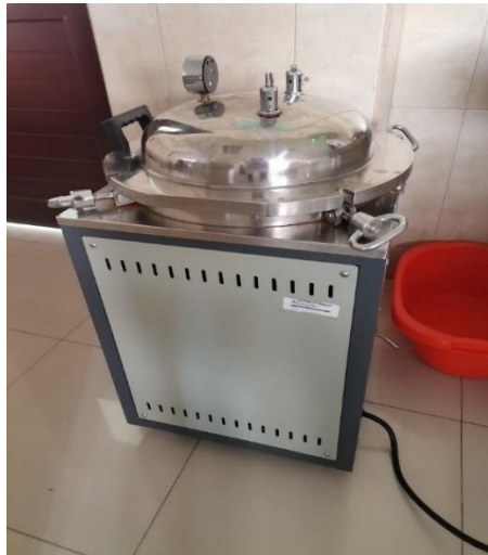
Figura 30. Esterilización de materiales de laboratorio vía húmeda.
