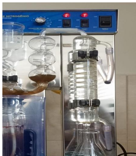
Figura 28. Destilador de nitrógeno del método de Kjeldahl para análisis de proteína.
