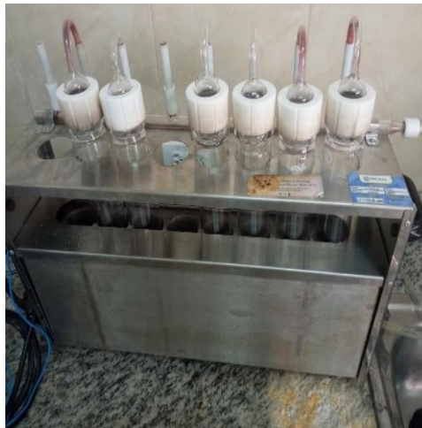
Figura 27. Digestión de muestras por método de Kjeldahl para análisis de proteína.
