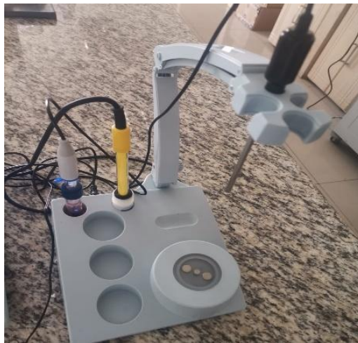
Figura 21. Potenciómetro para evaluar pH en yogur firme.
