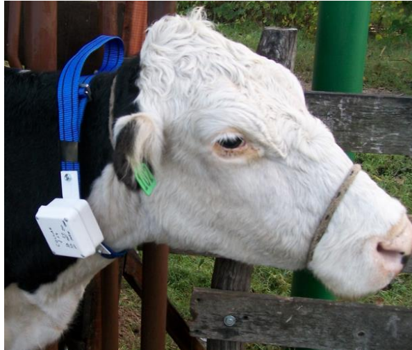
Figura 20. Dispositivo electrónico para monitoreo adaptado en collar.
