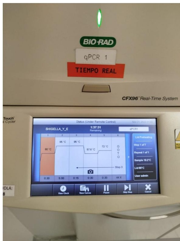
Figura 9. Condiciones de termociclador en tiempo real para la detección molecular de Shigella spp.
