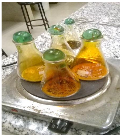
Figuras 32: Digestión ácida de muestras y determinación de Potasio (Espectrofotometría de absorción atómica)
