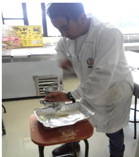
Figuras 30: Trituración de muestra seca de tubérculo y muestras foliares secas etiquetadas
