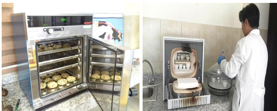
Figuras 29: Determinación de humedad y cenizas en muestras foliares y tubérculos
