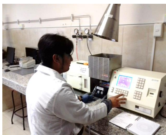
Figuras 31: Determinación de Nitrógeno (método Kjeldahl) y Fósforo (Espectrofotometría UV – VIS)
