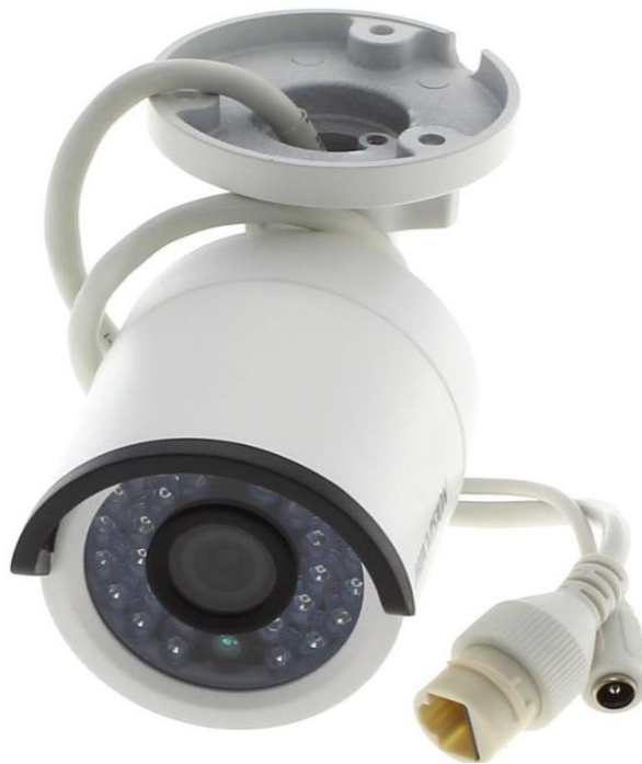
Figura 11. Cámara IR mini bullet network modelo DS-2CD2020F-I
