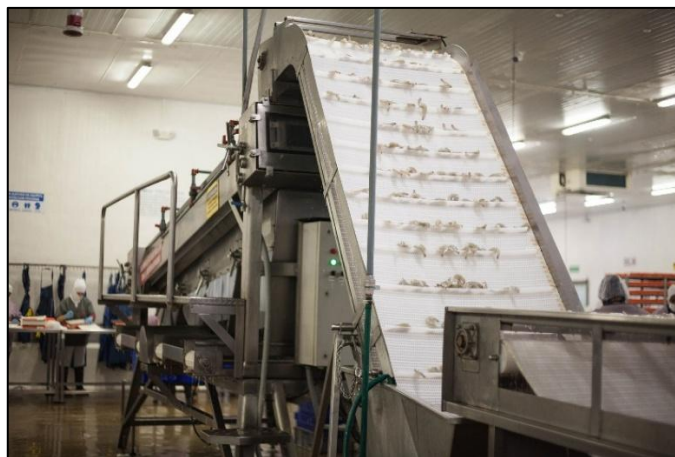
Figura 8. Máquina Balzo clasificadora de camarón
