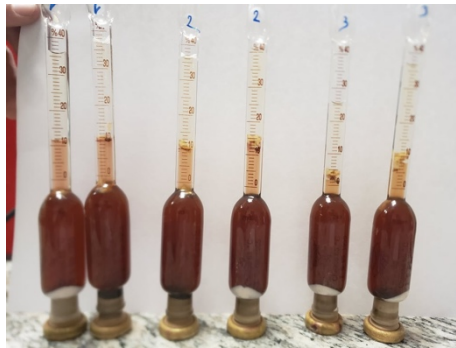
Fig. 13: Porcentaje de grasa para los tres mejores tratamientos obtenida mediante el método de Gerber.
