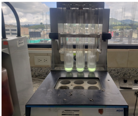
Fig. 14: Análisis de proteína mediante Kjendhal.
