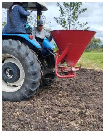
Figura 2. Voleadora acoplada al tractor Fuente: (Cuasapud, 2025)
