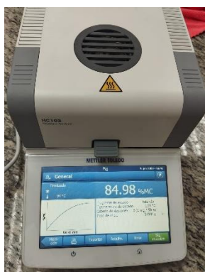
Figura 23. Humedad de la manzana
