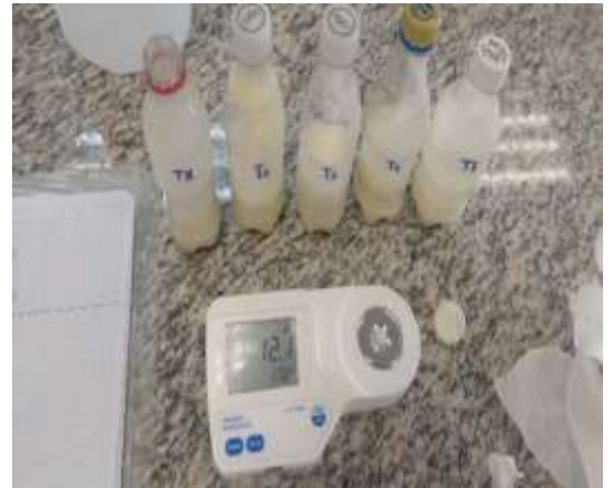
Figura 30. Refractómetro utilizado medición de °Brix
