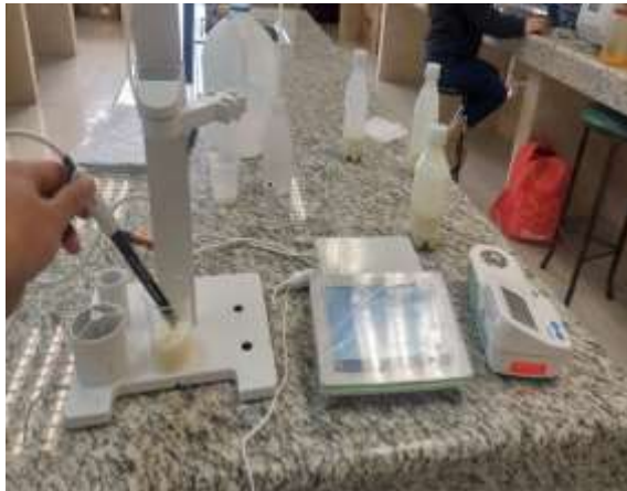
Figura 29. Potenciómetro utilizado medición de pH
