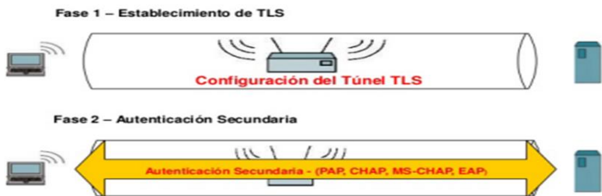
Figura 2. Funcionamiento de autenticación EAP-TTLS Fuente: Bosmediano y Cusme (2017)
