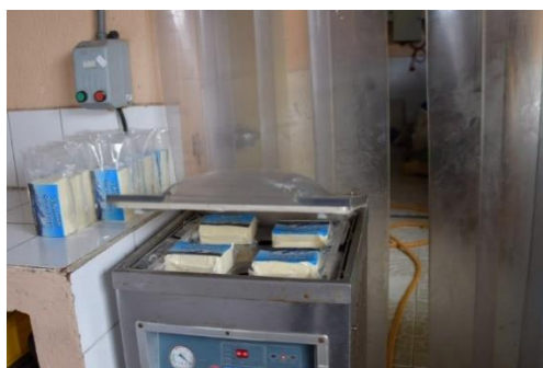
Ilustración 28 Envasadora al vacío Elaborado: Por la autora
