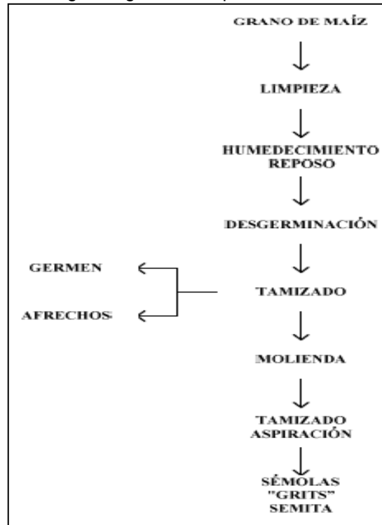
Gráfico 8. Diagrama general del proceso de molienda seca.
