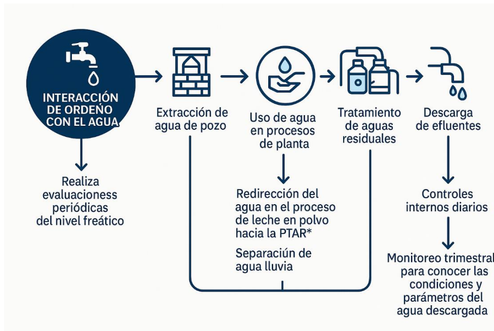
Cadena de interacción de agua en planta CORPABE
