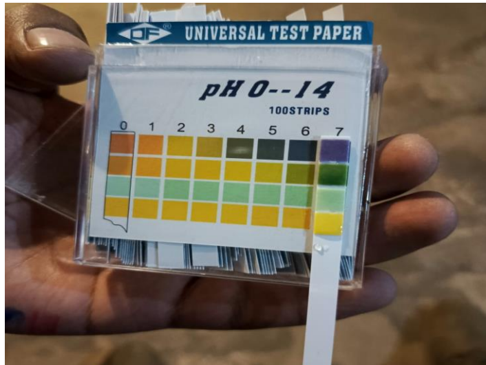
Figura 145. Test para medir ph
