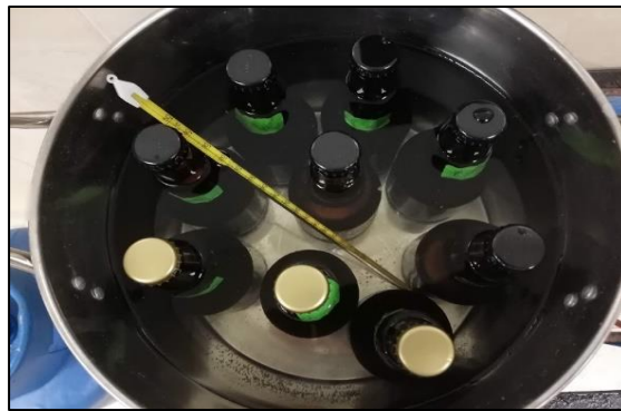
Figura 12. Pasteurización de la cerveza elaborada
