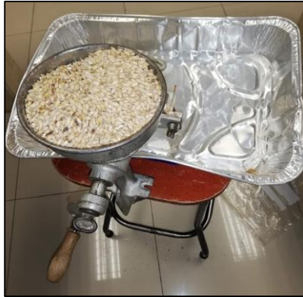
Figura 8. Molienda de malta base Pale Ale
