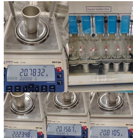
Figura 61. Determinación de grasa por el método de Soxhlet
