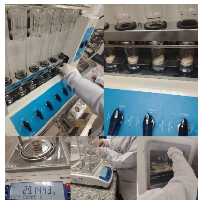
Figura 59. Determinación de fibra- Método weende
