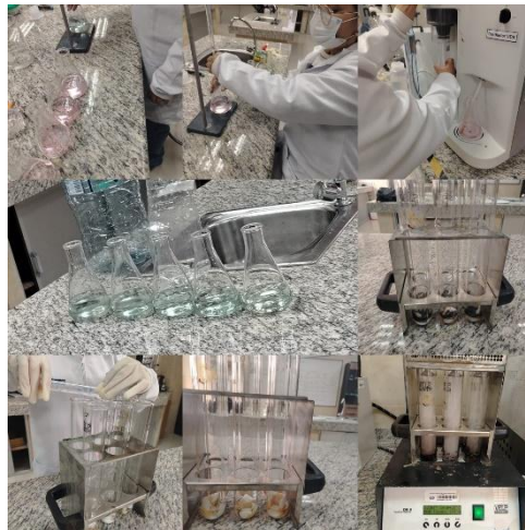
Figura 62. Proceso de digestión y destilación para proteína
