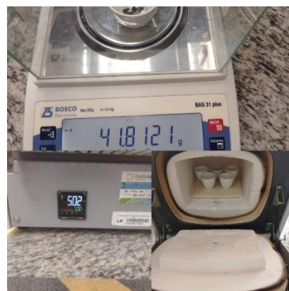
Figura 57. Determinación de cenizas por incineración
