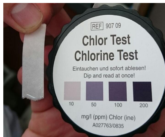
Figura 26: Prueba de verificación de cloro en el Agua Fuente: Laboratorio de la Industria Lechera
