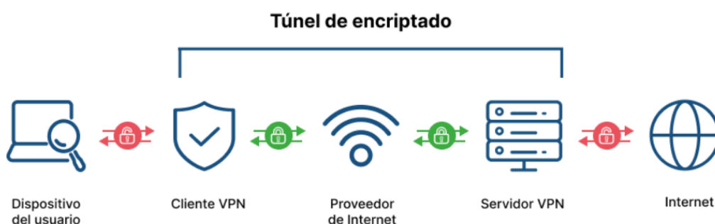
Figura 8. Funcionamiento de un túnel VPN.
