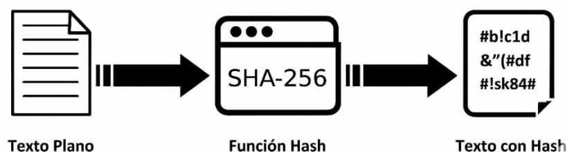
Figura 7. Modelo de funcionamiento del algoritmo Hash.
