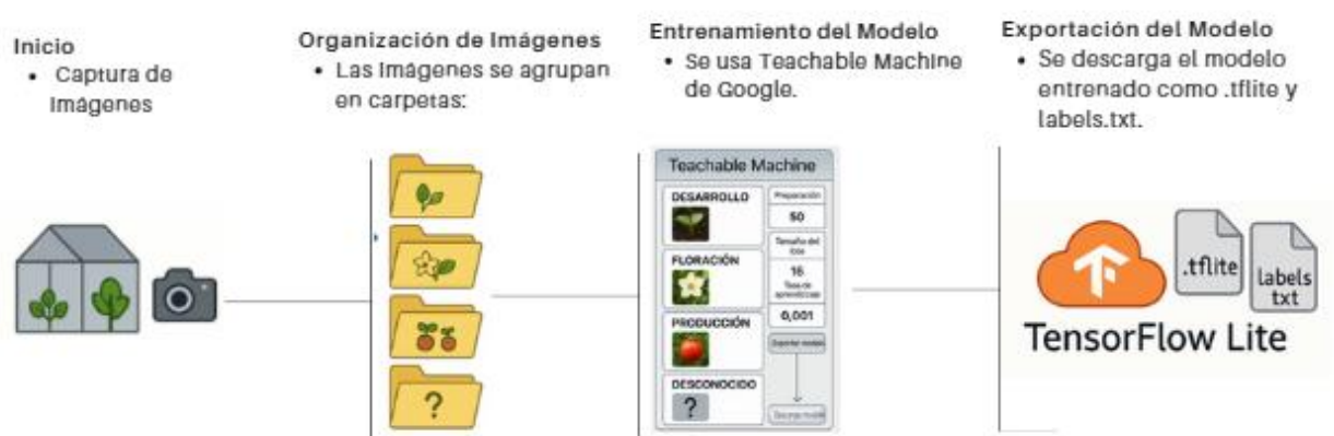
Figura 4. Diagrama de flujo model_unquant.tflite
