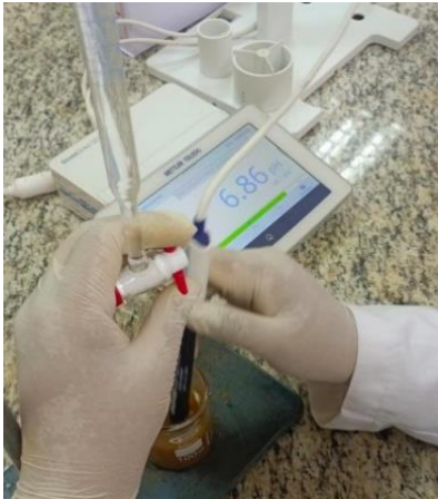
Figura 23. Análisis de pH en las muestras
