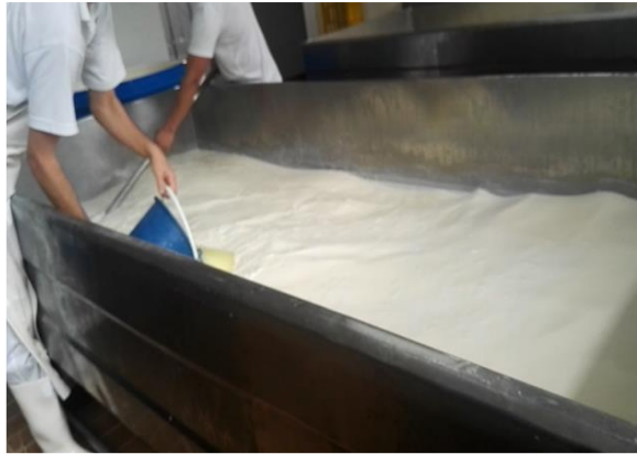
Figura 21. Proceso de adición de cuajo
