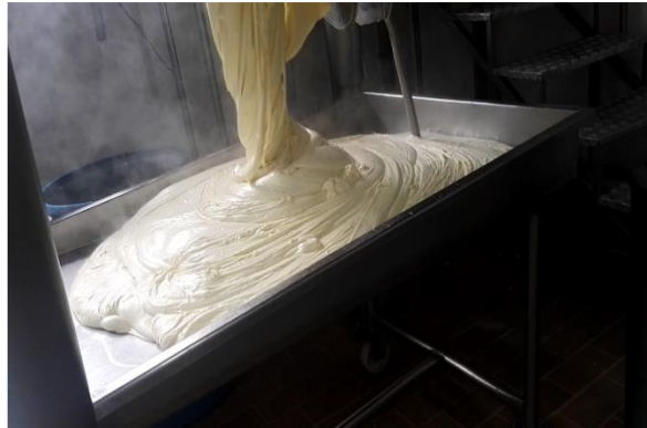
Figura 27. Proceso de hilado
