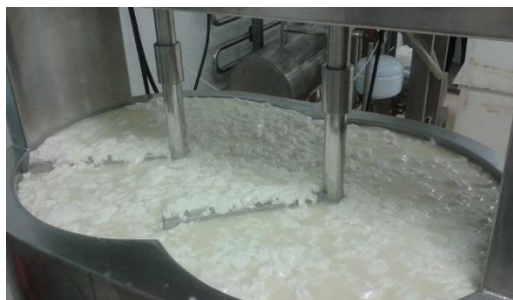
Figura 23. Proceso de corte de la cuajada
