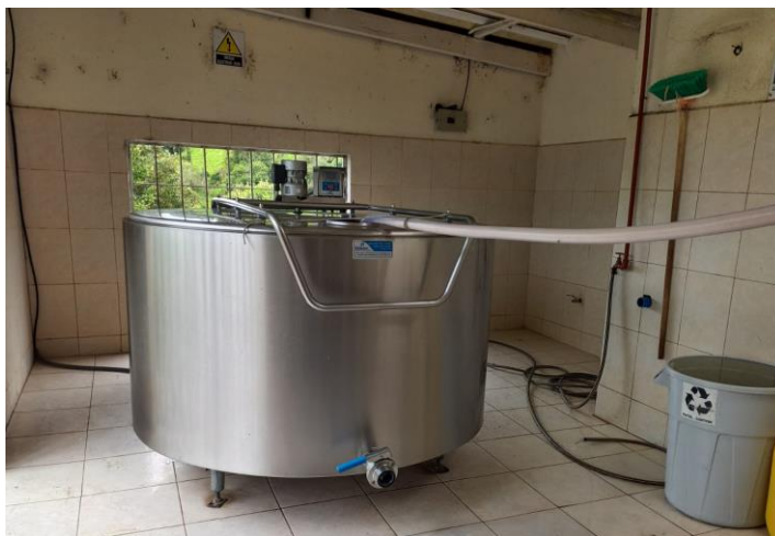
Figura 14. Tanque de enfriamiento de la leche cruda
