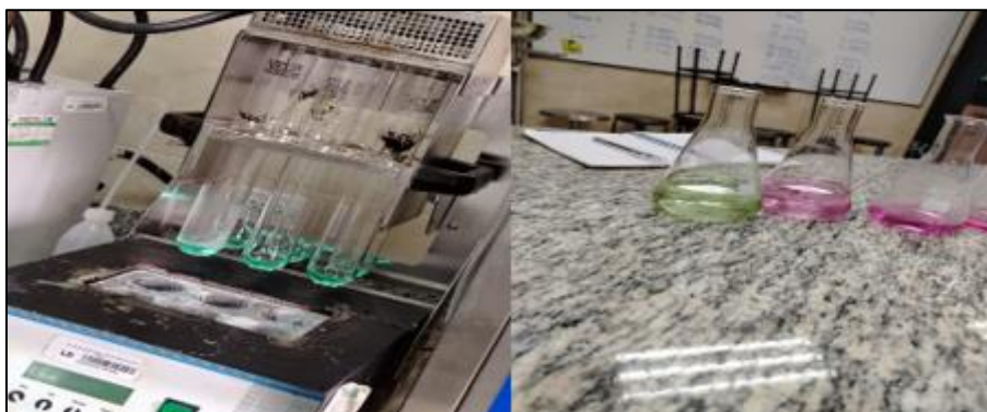
Figura 34. Determinación del porcentaje de proteína por el método de Kjeldahl.
