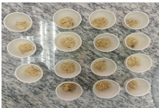
Figura 5. Muestras del pan en crisoles para análisis de humedad
