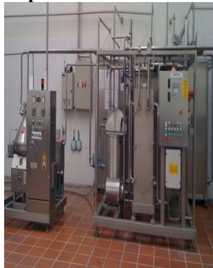
Pasteurizador a placas de 5 etapas
