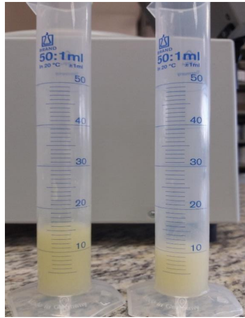
Figura 15. Medición de sinéresis entre el yogur testigo y el yogur con inulina
