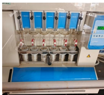
Figura 45. Determinación del contenido de grasa por el método de Soxhlet.
