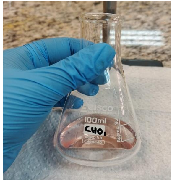
Figura 50. Titulación de la muestra de harina para acidez.
