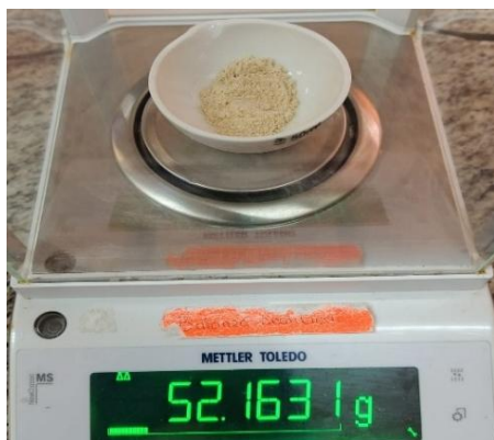
Figura 41. Peso del crisol con la muestra de harina para determinar humedad.
