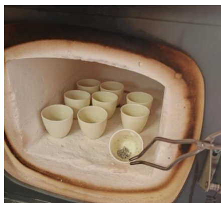
Figura 46. Determinación del contenido de cenizas por incineración.
