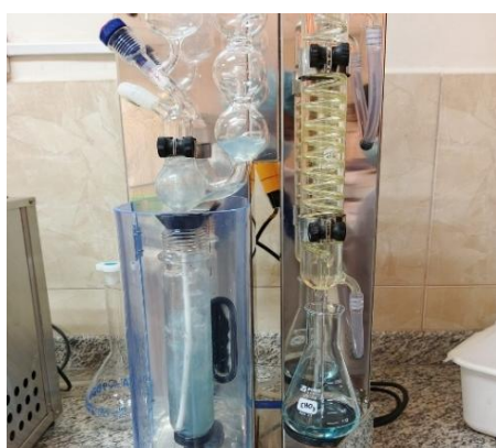
Figura 43. Proceso de destilación para análisis de proteína.
