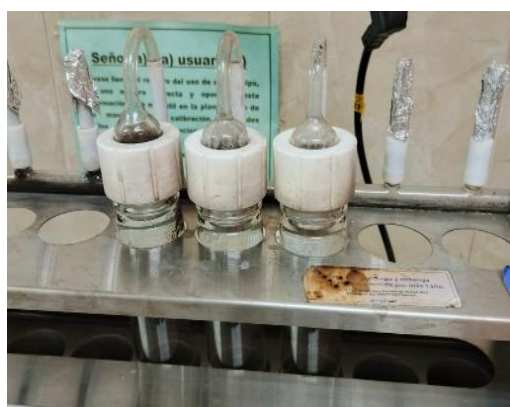
Figura 42. Proceso de digestión del para determinación de proteína.
