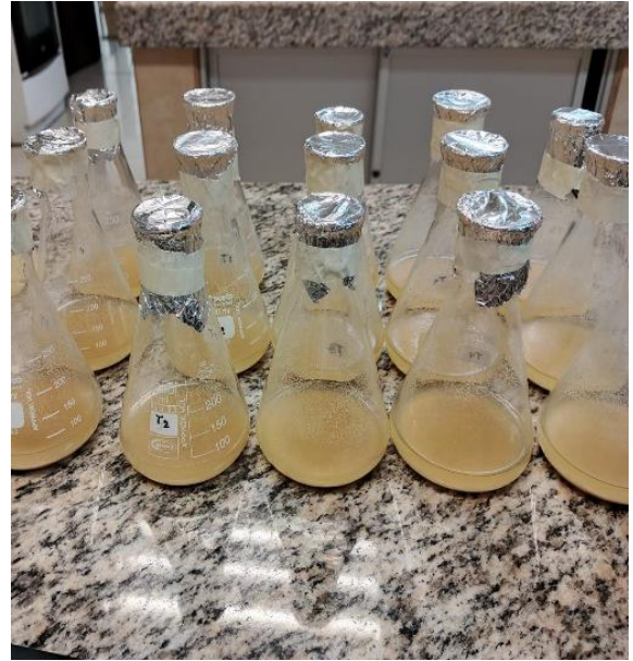
Figura 49. Preparación de muestras para determinar acidez en harina.
