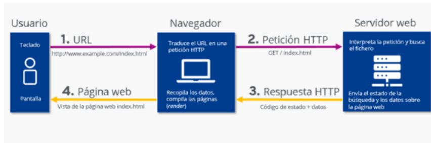
Figura 23. Proceso de comunicación HTTP Fuente: Protocolo HTTP según Digital IONOS
