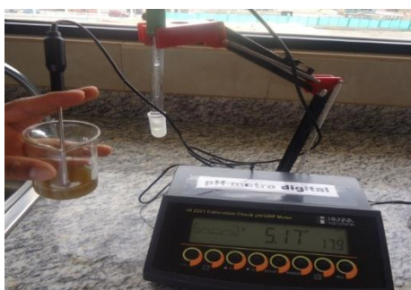
Fotografía 2: Medición de pH
