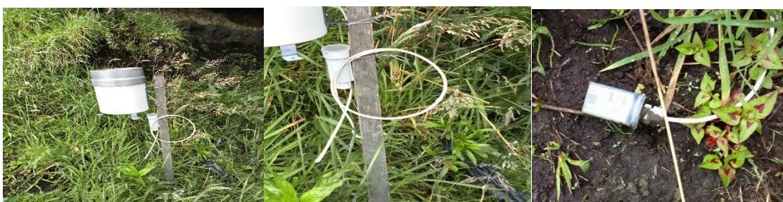
Figura 21. Instalación y revisión de sensores de lluvia y temperatura en la zona de estudio.
