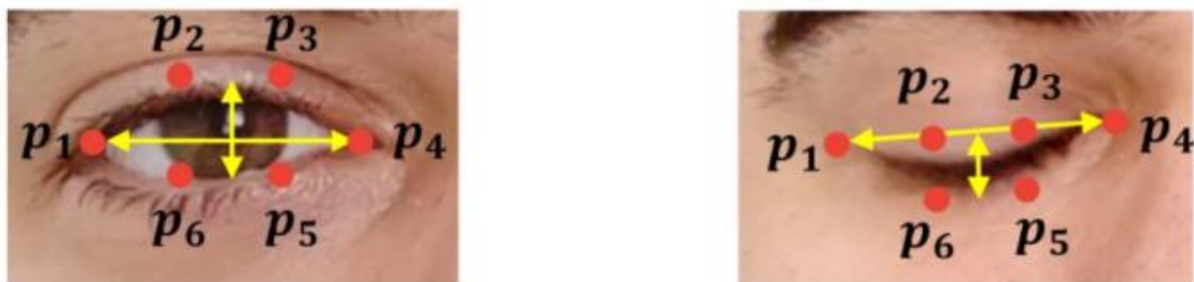
Figura 84. Cálculo de longitudes verticales y horizontales para detectar cuando parpadea el conductor
