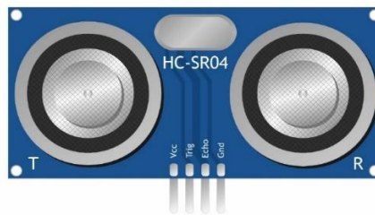
Figura 4: Sensor ultrasónico HC-SR04 Fuente: (Intesc, 2021)
