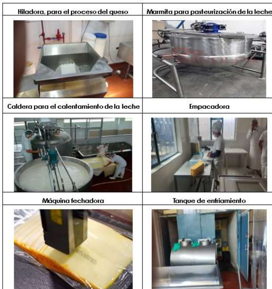
Figura 7. Maquinaria para la producción de queso Mozzarella
