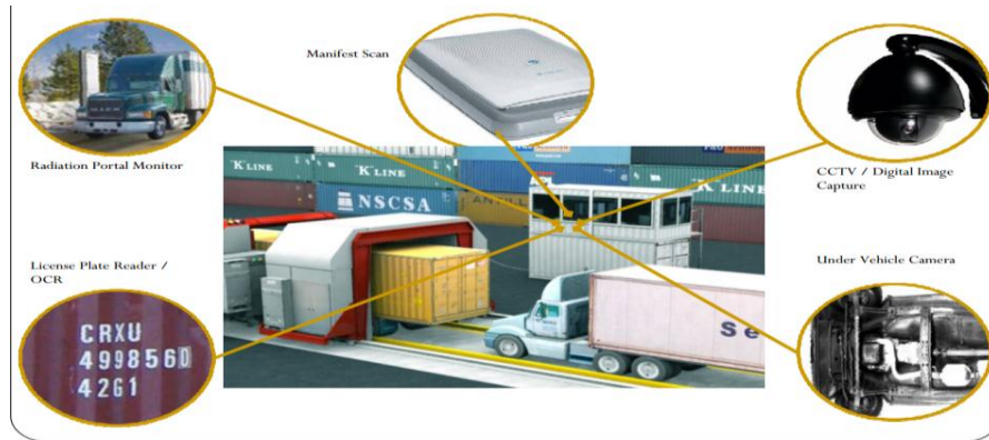
Figura 65: Inspección de contenedores
