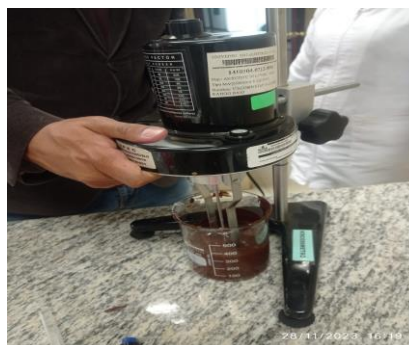
Fotografía 10. Medición de viscosidad
