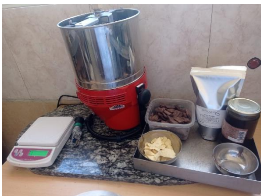
Fotografía 5. Mezcla y refinamiento de chocolate
