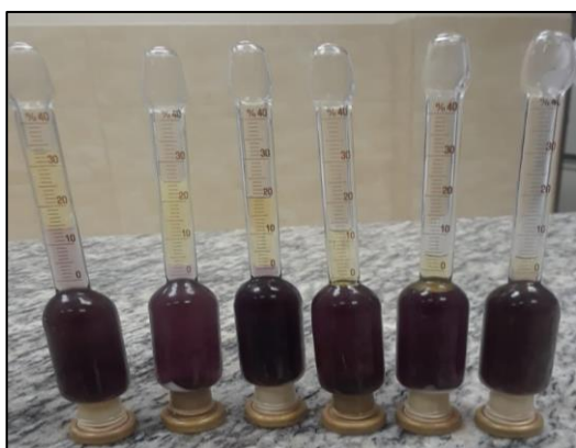
Figura 8: Análisis de grasa método Gerber
