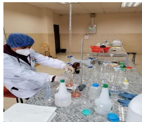
Figura 30. Titulación para determinar proteína.
