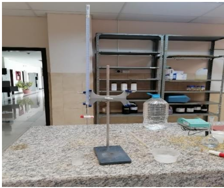
Figura 33. Determinación de la acidez titulable.
