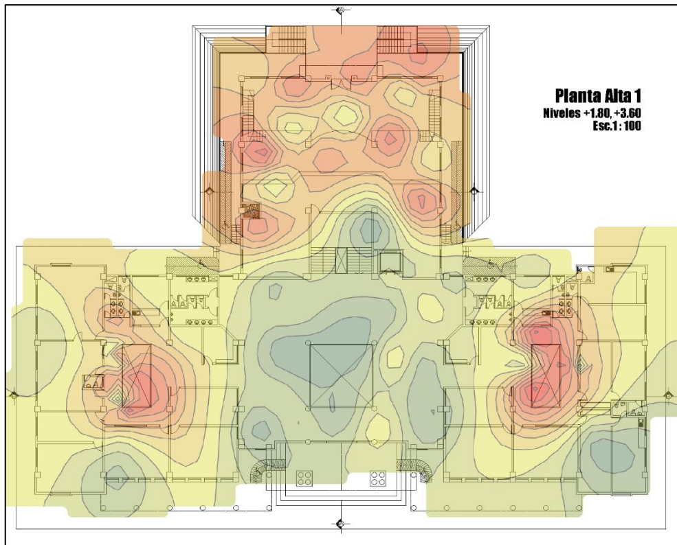
Figura 75. Cobertura wifi en edificio principal - planta alta 1
