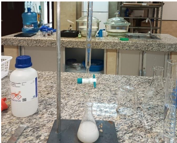
Figura 30. Estandarización solución Tiosulfato de sodio 0,1 N
