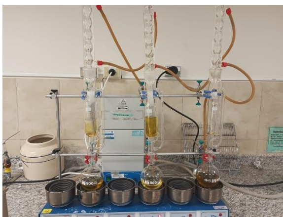
Figura 11. Extracción de antioxidantes por Soxhlet
