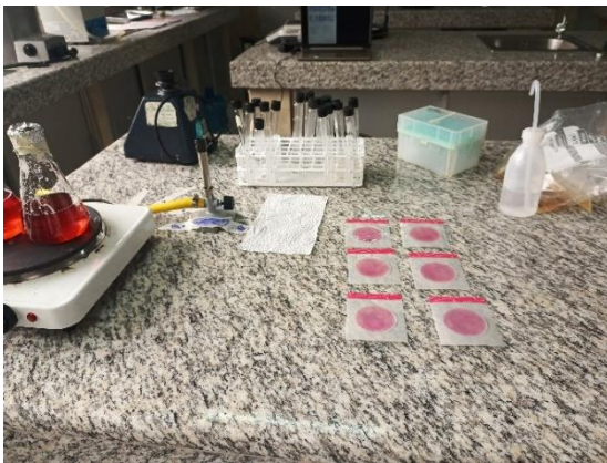
Figura 25. Análisis de E. coli y Coliformes por placas petrifilm
