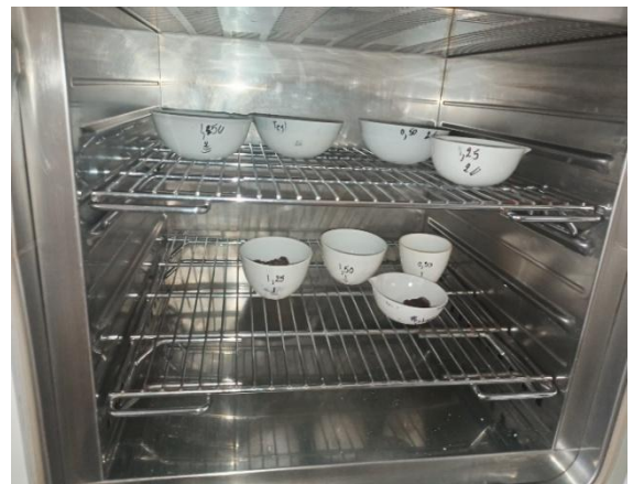
Figura 20. Determinación de humedad
