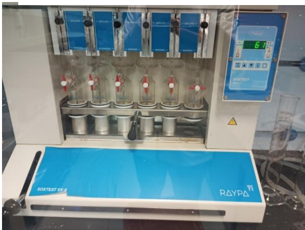
Figura 19. Determinación de grasa por Soxhlet
