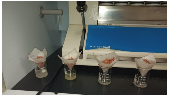
Figura 29. Extracción de parte grasa de las muestras para determinación de peróxidos.
