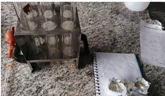
Figura 9. Muestras pesadas en papel libre de nitrógeno listas para transferirlas al tubo de digestión.
