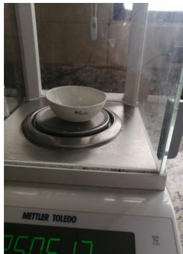
Figura 28. Pesado final de la muestra.
