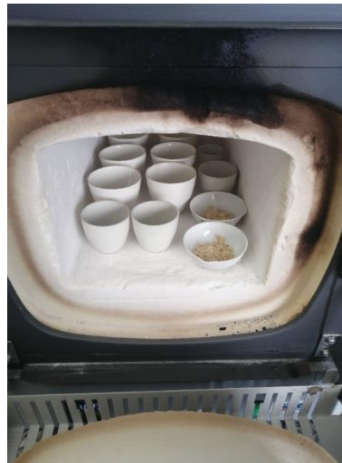
Figura 26. Muestras en la mufla.
