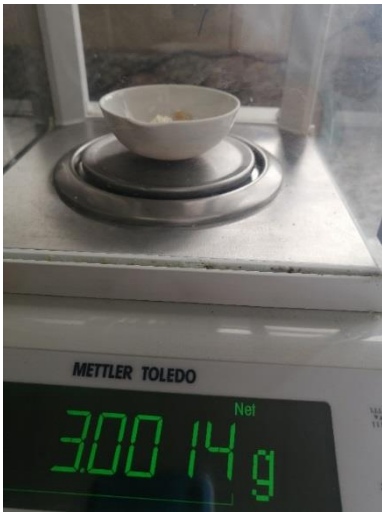
Figura 25. Pesado inicial de la muestra.
