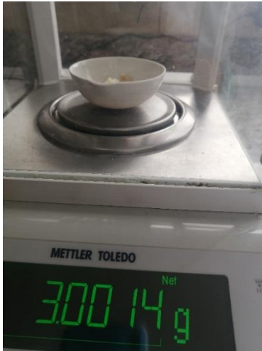
Figura 6. Pesado de la muestra.
