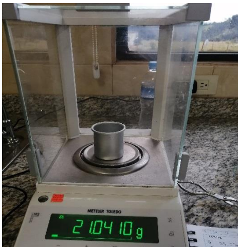
Figura 23. Pesado final del dedal.
