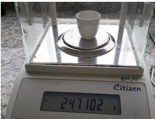
Figura 18. Tarado de la muestra más crisol
