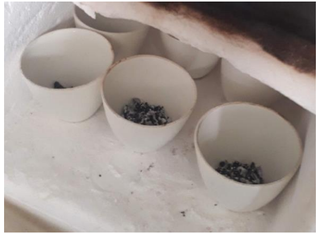
Figura 19. Muestras en mufla para determinación de ceniza
