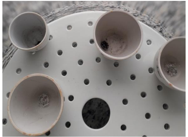
Figura 20. Muestras de ceniza en desecador
