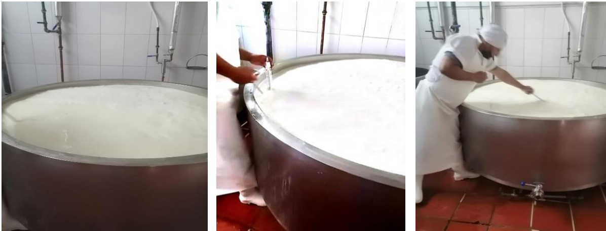
Figura 23. Tratamiento térmico - Pasteurización 72°C
