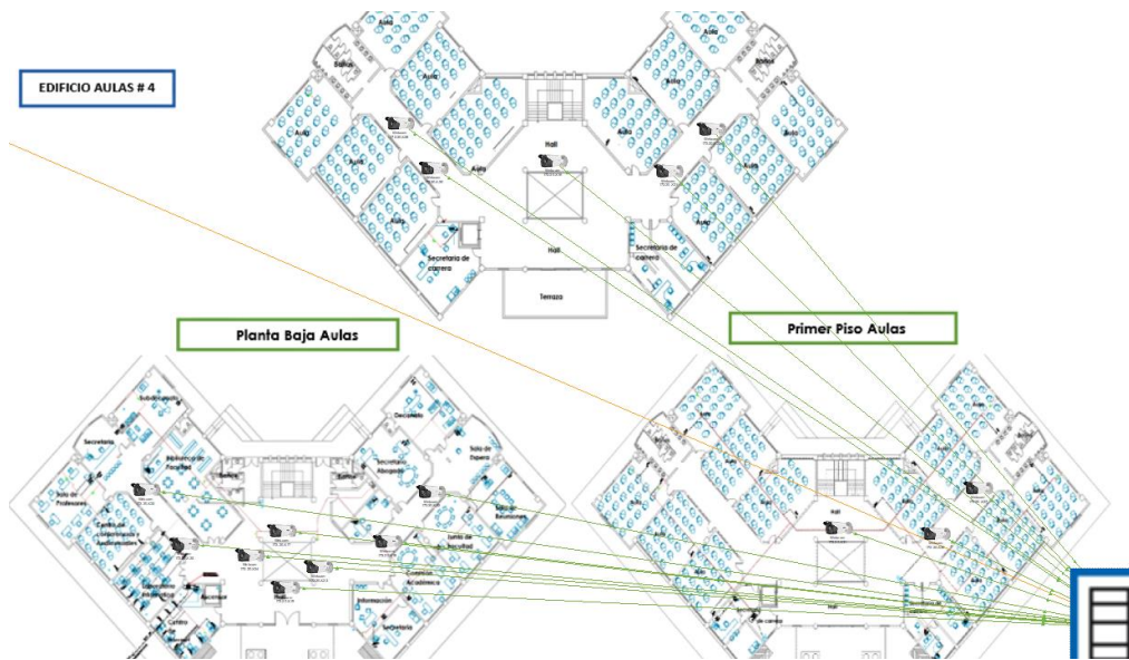
Figura 81. Estructura de conexión, cámaras en el Edificio Aulas # 4.
