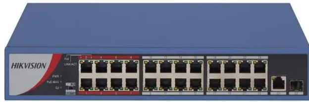
Figura 58. Conmutador POE no administrado Fast Ethernet de 24 puertos
