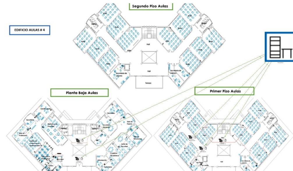
Figura 49. Diseño físico de las cámaras en Edificio de aulas # 4.
