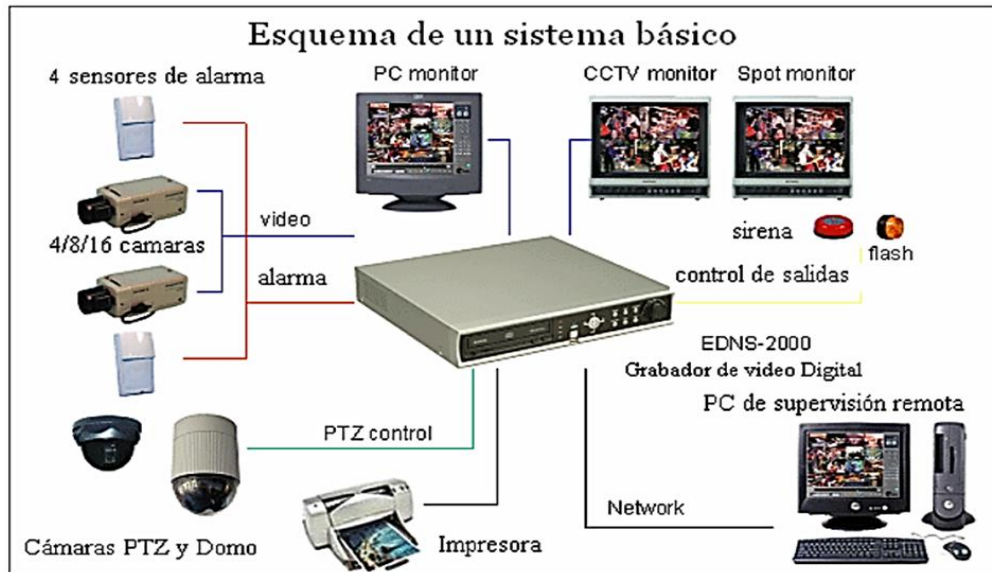
Figura 1. Sistema de CCTV en general Fuente: Mata (2018)
