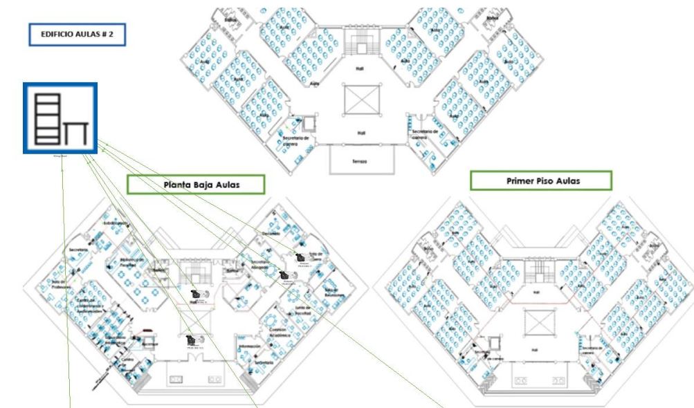
Figura 47. Diseño físico de las cámaras en Edificio de aulas # 2.
