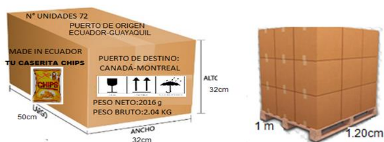
Ilustración 24: Dimensiones del contenedor
